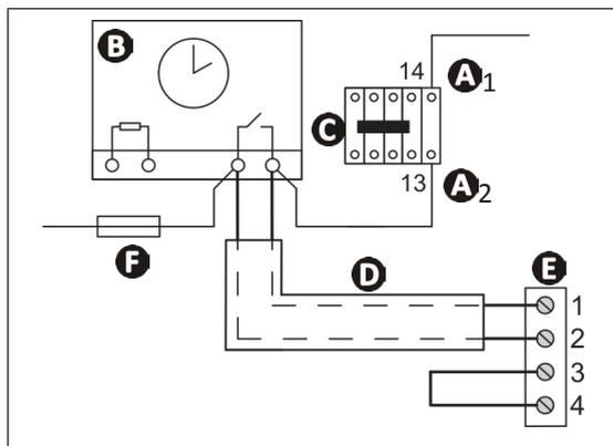
**A1- A2** : alimentation de la bobine du contacteur de puissance de la pompe de filtration
